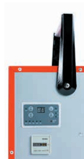
Bedienungspanel und Betriebsstundenzähler
